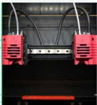
**Sistema de Duplo Extrusor Independente (INDEX) para modo de duplicação ou peças espelhadas**
